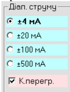
Чекбокс "К.перегр." (контроль перегрузки) активує захист від перевищення струму – якщо під час вимірювань струм вийде за допустимі межі вибраного діапазону, то експеримент буде досить зупинено. Оператор вибирає потрібний метод дослідження кліком на відповідний режим роботи пристрою:
