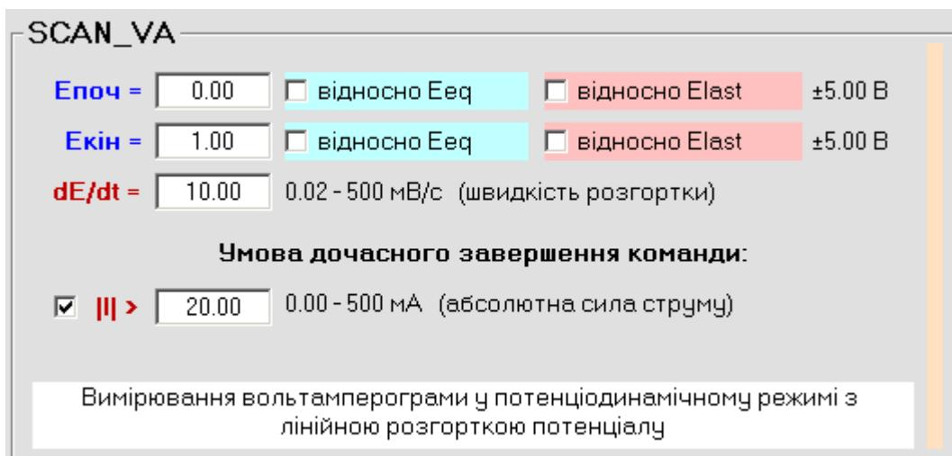
Виконання розгортки може бути завершено дочасно, якщо активовано умову – досягнення певного граничного струму **III**. Ця умова корисна, наприклад, при реалізації циклічної вольтамперометрії (ЦВА), коли треба автоматично змінювати напрям розгортки при досягненні певного граничного струму.
