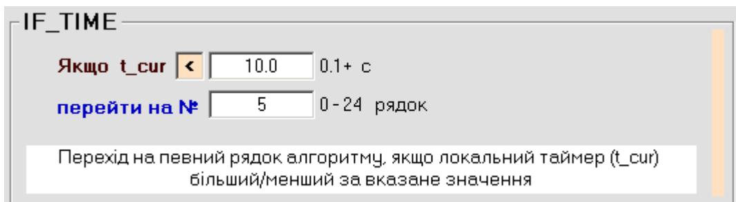
За цією командою пристрій перевіряє значення локального таймера (*t\_cur*) і якщо воно менше/більше за вказане значення, то здійснює переход на вказаний рядок алгоритму. Якщо ж умова не виконується, то буде переход на наступний рядок алгоритму.
