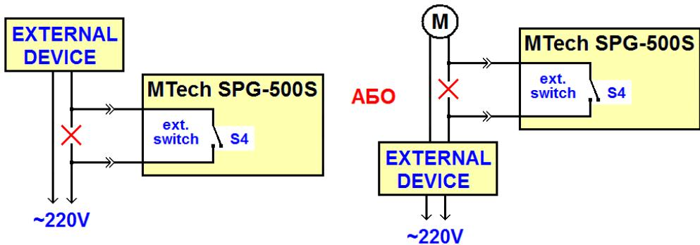
Реле S4 може комутувати постійний чи змінний струм до 0,5 А.
