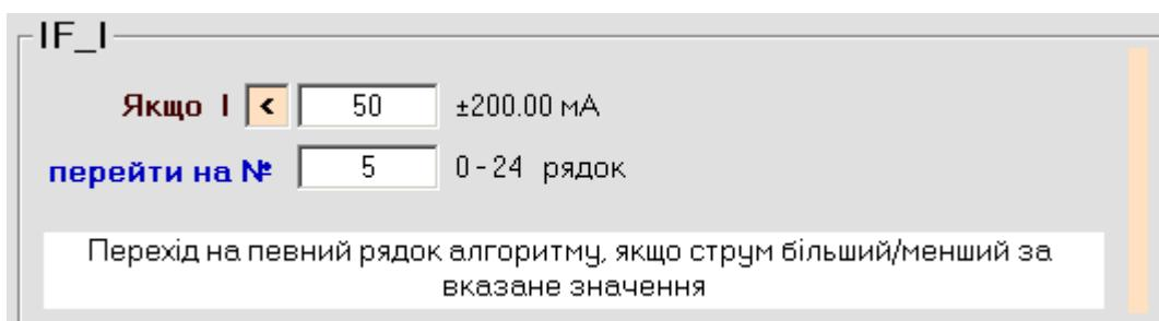
За цією командою пристрій виконує однократне вимірювання і якщо струм менший/більший за вказане значення, то здійснює перехід на вказаний рядок алгоритму. Якщо ж умова не виконується, то буде перехід на наступний рядок алгоритму.
