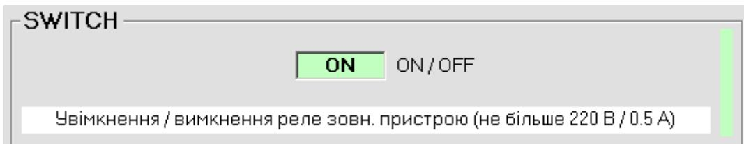
По-замовчуванню це реле завжди вимкнуте, оскільки на початку і після завершення виконання алгоритму пристрій його автоматично вимикає.
