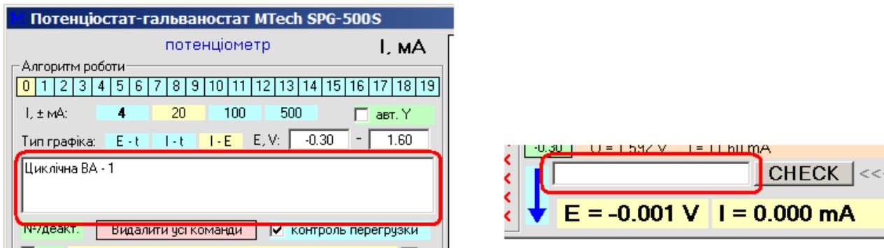
Для використання приладу як звичайного потенціометра/іономіра (наприклад при потенціометричному титруванні) складати алгоритм вимірювань не треба – по-замовчуванню після запуску програми чи після завершення роботи алгоритму вимірювань прилад перебуває саме у стані потенціометра і неперервно відображає поточне значення потенціалу робочого електрода:
