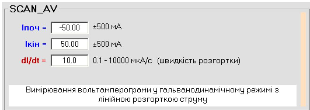
Вимірювання вольтамперної залежності у гальванодинамічному варіанті найчастіше використовують при дослідженні об'єктів з малим внутрішнім опором, наприклад суперконденсаторів.
