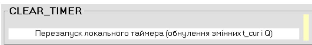
Локальний таймер ( $t_{cur}$ ) в основному використовують для контролю пропущеної/одержаної електрики ( $Q$ ), яка обчислюється ПЗ шляхом інтегрування кривої  $I-t_{cur}$ . У циклічних експериментах, наприклад при циклованні ХДС, зручно коли ємність обчислюється і реєструється окремо для кожного етапу заряджання/розряджання – саме для цього на початку кожного етапу ставлять команду **CLEAR\_TIMER**.
