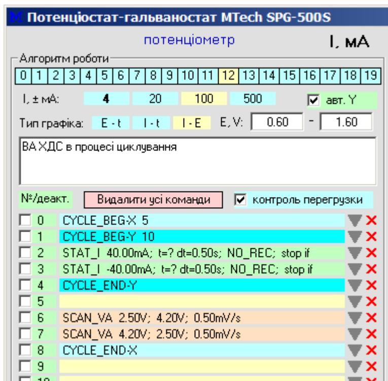
Пояснення. Тут задіяно подвійний вкладений цикл. Цикл (Х) задає 5 етапів проходження циклування і вимірювання ВА. Для самого циклування задіяно внутрішній цикл (Y). Отже, перед вимірюванням кожної ВА буде виконано 10 етапів заряд/розряд струмом 40 мА.
