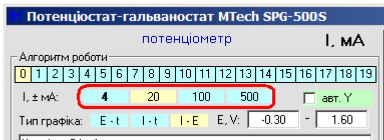
– вибирає тип графіка, який по замовчуванню повинен відображатись в процесі вимірювань (потім його можна змінити вручну):
