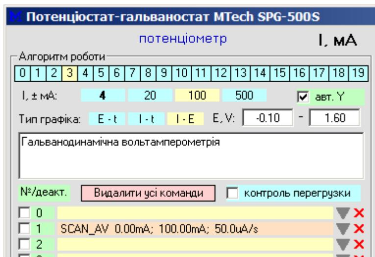
Як бачимо, для вимірювання ВА у гальванодинамічному варіанті задіяно команду SCAN\_AV. Аналогічно можна реалізувати вимірювання ЦВА у такому варіанті – для цього слід задати циклічний алгоритм з двома такими командами у тілі циклу, подібно як у прикладі №1.
