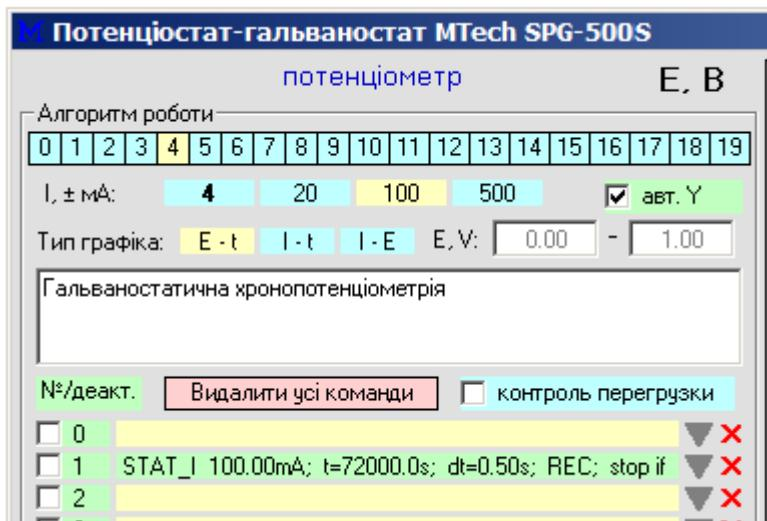
Для такого дослідження задіяно команду STAT\_I ("галваностат"), у параметрах якої задають значення струму, граничну тривалість, кінцеву напругу та періодичність вимірювання і відкладання на графік точок.
