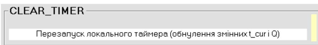
Локальний таймер ( $t_{cur}$ ) використовують для контролю тривалості певного етапу експерименту чи обчислення пропущеної/одержаної електрики ( $Q$ ), яку ПЗ знаходить шляхом інтегрування кривої  $I-t_{cur}$ . У циклічних експериментах, наприклад при циклуванні ХДС, зручно коли ємність обчислюється і реєструється окремо для кожного етапу заряджання/розряджання – саме для цього на початку кожного етапу ставлять команду **CLEAR\_TIMER**.
