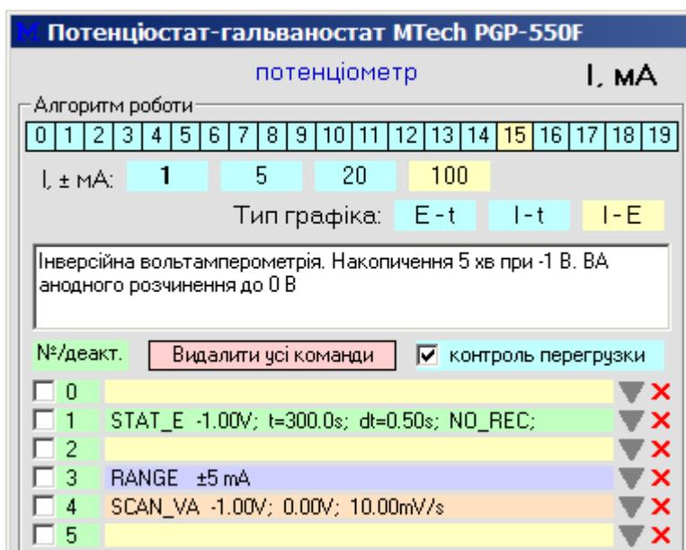
**Пояснення.** Спочатку поляризуємо електрод при -1 В впродовж 300 с (5 хв). Якщо при анодному розчиненні очікуються менші струми, то доцільно перейти на нижчий діапазон струмів (рядок №3) перед вимірюванням вольтамперограми. Останньою командою вимірюємо ВА анодного розчинення накопичених продуктів.
