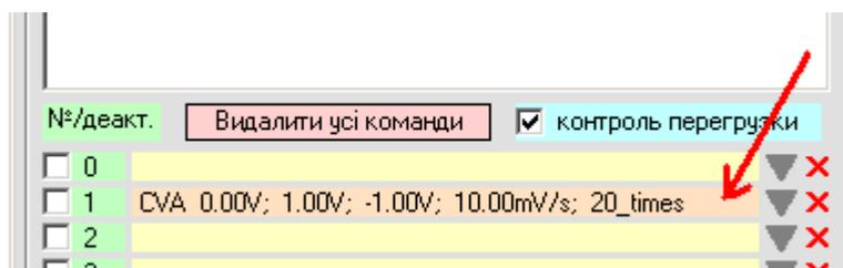
На вищезазначеному рисунку у рядок №1 внесено команду для вимірювання циклічної вольтамперограми.
