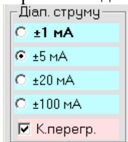
Чекбокс "К.перегр." (контроль перегрузки) активує захист від перевищення струму – якщо в під час вимірювань струм вийде за допустимі межі вибраного діапазону, то експеримент буде дочасно зупинено. Оператор вибирає потрібний метод дослідження кліком на відповідний режим роботи пристрою:
