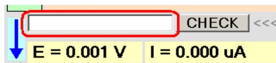
Для використання приладу як звичайного потенціометра/іономіра (наприклад при потенціометричному титруванні) складати алгоритм вимірювань не треба – по-замовчуванню після запуску програми чи після завершення роботи алгоритму вимірювань прилад перебуває саме у стані потенціометра і неперервно відображає поточне значення потенціалу робочого електрода:
