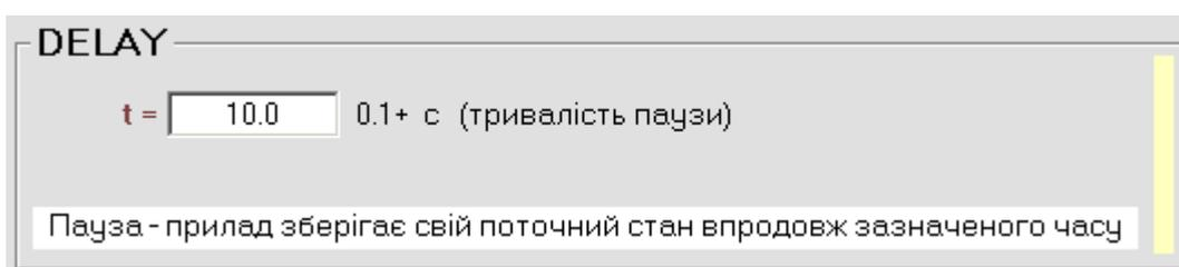
Пристрій зберігає свій поточний стан впродовж зазначеного часу не виконуючи жодних вимірювань.
