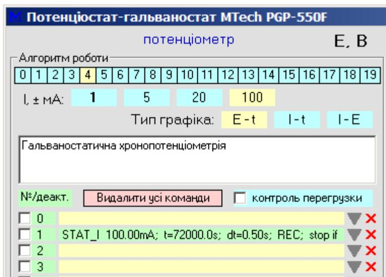
Для такого дослідження задіяно команду STAT\_I ("гальваностат"), у параметрах якої задають значення струму, граничну тривалість, кінцеву напругу та періодичність вимірювання і відкладання точок на графік.
