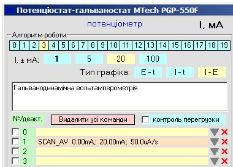
Як бачимо, для вимірювання ВА у гальванодинамічному варіанті задіяно команду SCAN\_AV. Аналогічно можна реалізувати вимірювання ЦВА у такому варіанті – для цього слід задати циклічний алгоритм з двома такими командами у тілі циклу, подібно як у прикладі №1.
