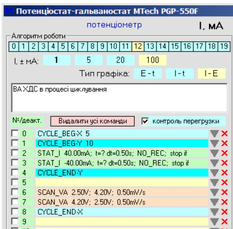
Пояснення. Тут задіяно подвійний вкладений цикл. Цикл (X) задає 5 етапів проходження циклування і вимірювання ВА. Для самого циклування задіяно внутрішній цикл (Y). Отже, перед вимірюванням кожної ВА буде виконано 10 етапів заряд/розряд струмом 40 мА. Якщо під час вимірювання ВА струм не перевищує 20 мА, то доцільно таке вимірювання виконувати на тоншому діапазоні струму, додавши в алгоритм відповідні команди RANGE:
