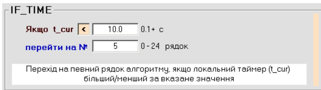
За цією командою пристрій перевіряє значення локального таймера ( $t_{cur}$ ) і якщо воно менше/більше за вказане значення, то здійснює перехід на вказаний рядок алгоритму. Якщо ж умова не виконується, то буде перехід на наступний рядок алгоритму.
