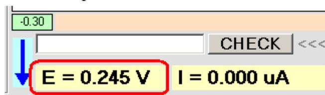
В процесі виконання алгоритму експерименту програма відображає на графічному полі вибраний тип залежності, а також показує поточні значення потенціалу, струму, останнє вимірне значення потенціалу розімкнутого кола ( $E_{eq}$ ) та кількості електрики ( $Q$ ). За потреби оператор може змінювати тип відображуваного графіка:
